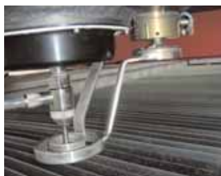
Датчик контроля вты и устройство противостолкновений Touch Probe and Anti-Collision Device
