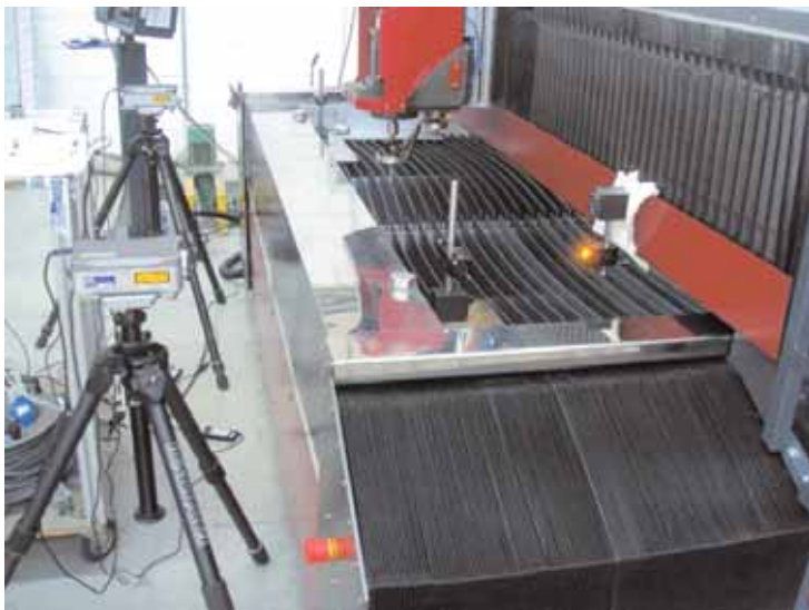
Лазер Renishaw для проверки прямолинейности и точности позиционирования
